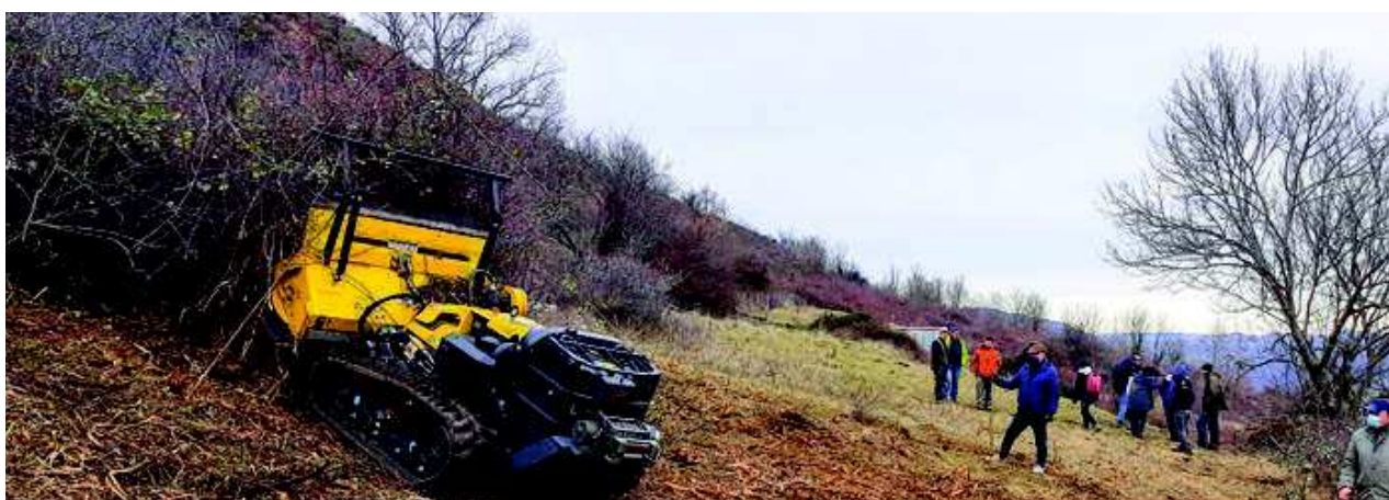
Nettoyage d'un terrain très embroussaillé au moyen d'un tracteur débroussailleur télécommandé
